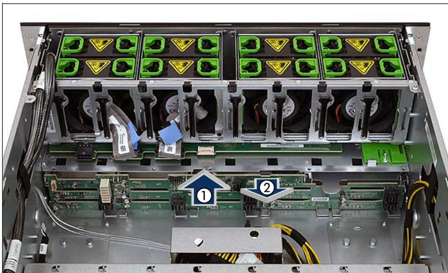
図 30: HDD バックプレーンの取り外し
