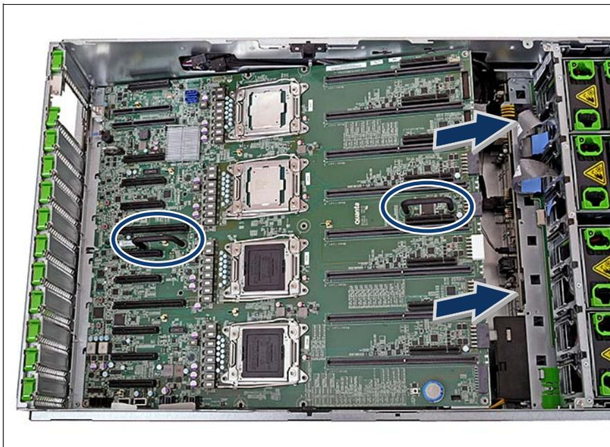
図 175: システムボードの取り外し
