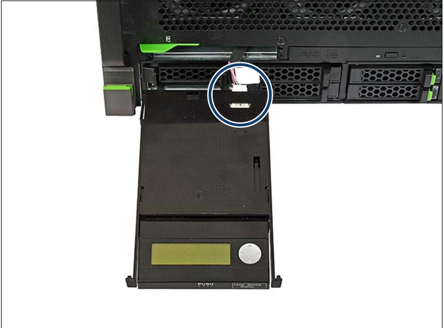
図 148: LSD モジュールへのケーブルの接続
