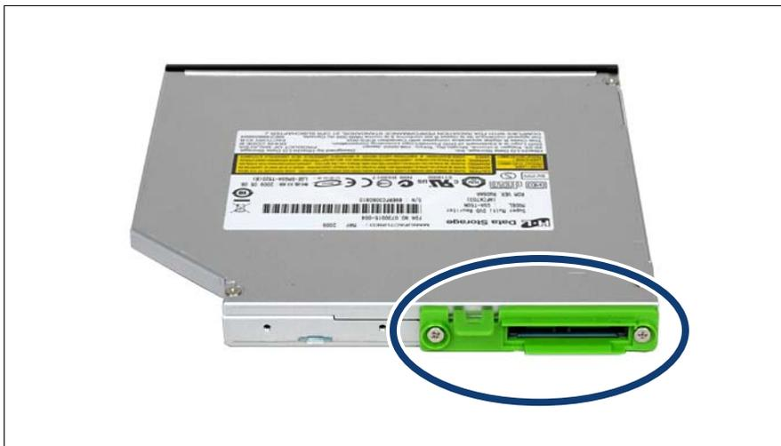
図 151: 新しい光ディスクドライブへのコネクタの取り付け
