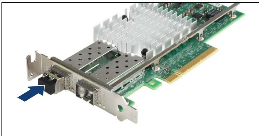
図 82: 光ポート保護プラグの取り付け
