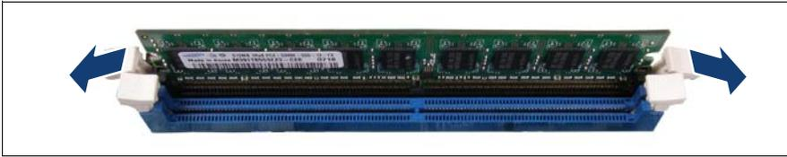
図 116: メモリモジュールの取り外し (A)
