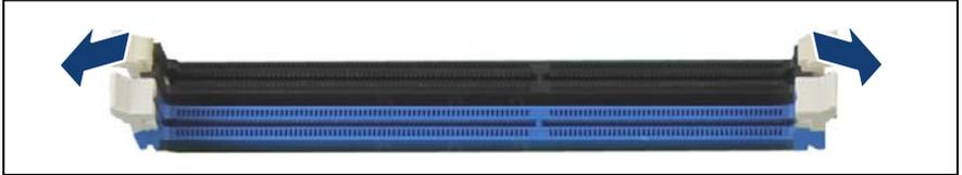
図 112: メモリモジュールの取り付け (A)
