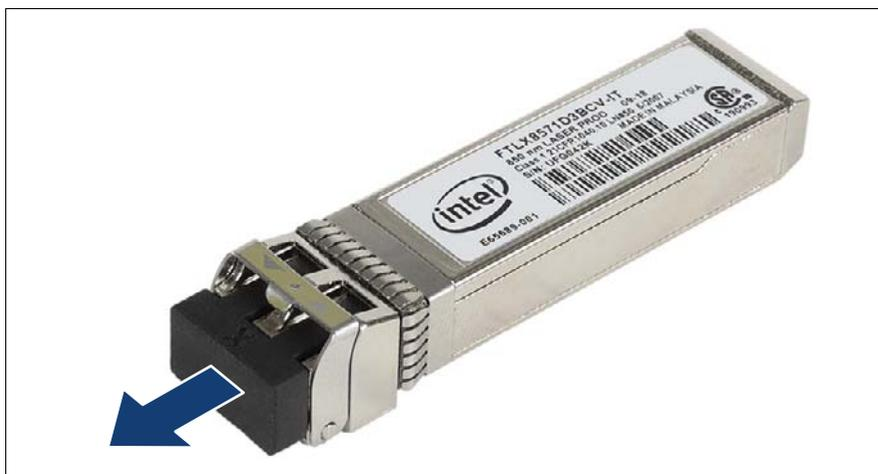
図 78: 光ポート保護プラグの取り外し
