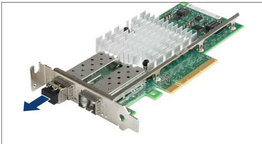
図 84: 光ポート保護プラグの取り外し
