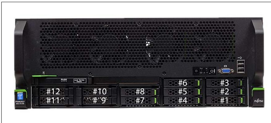
図 24: 2.5 インチ HDD/SSD スロットの割り当て
