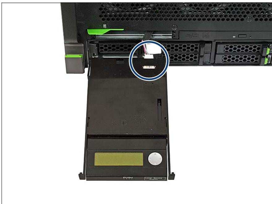
図 147: LSD モジュールからのケーブルの取り外し
