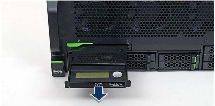
図 146: ベイからの LSD モジュールの引き出し
