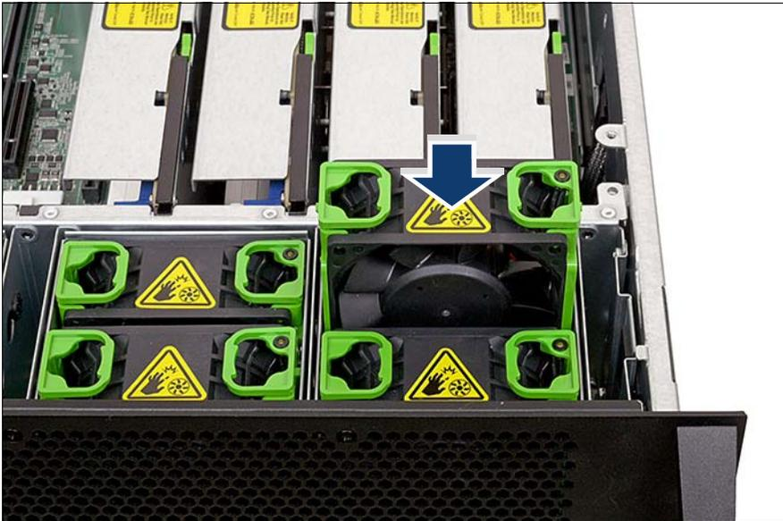
図 34: システムファンモジュールの取り付け
