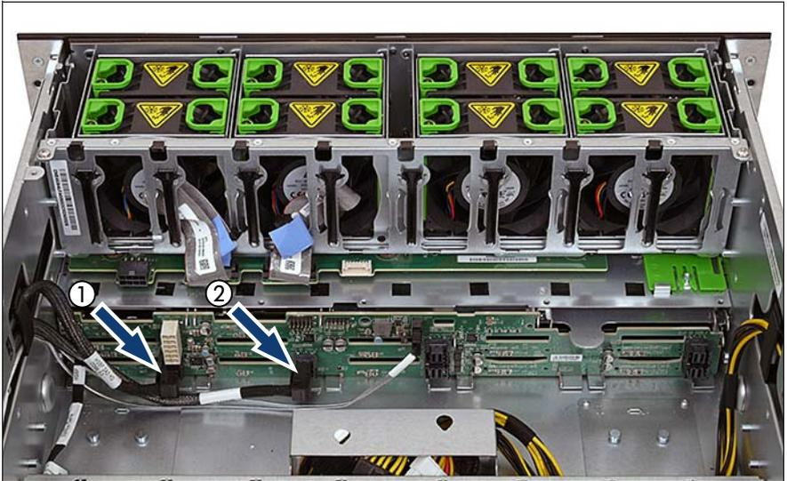
図 32: SAS および SATA ケーブルの HDD バックプレーンへの接続
