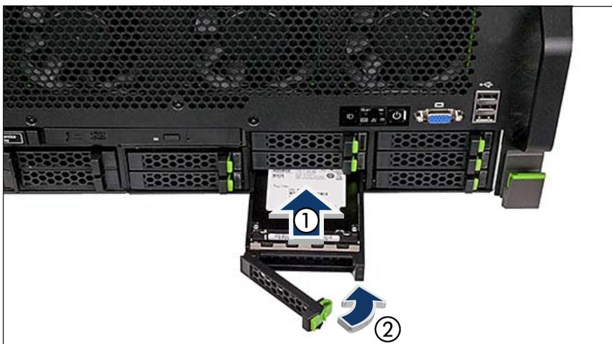
図 26: 2.5 インチ HDD/SSD モジュールの取り付け
