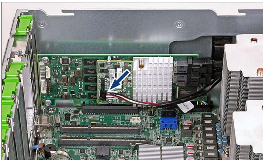
図 73: SAS ライザー (D3216) の TFM への FBU ケーブルの接続
